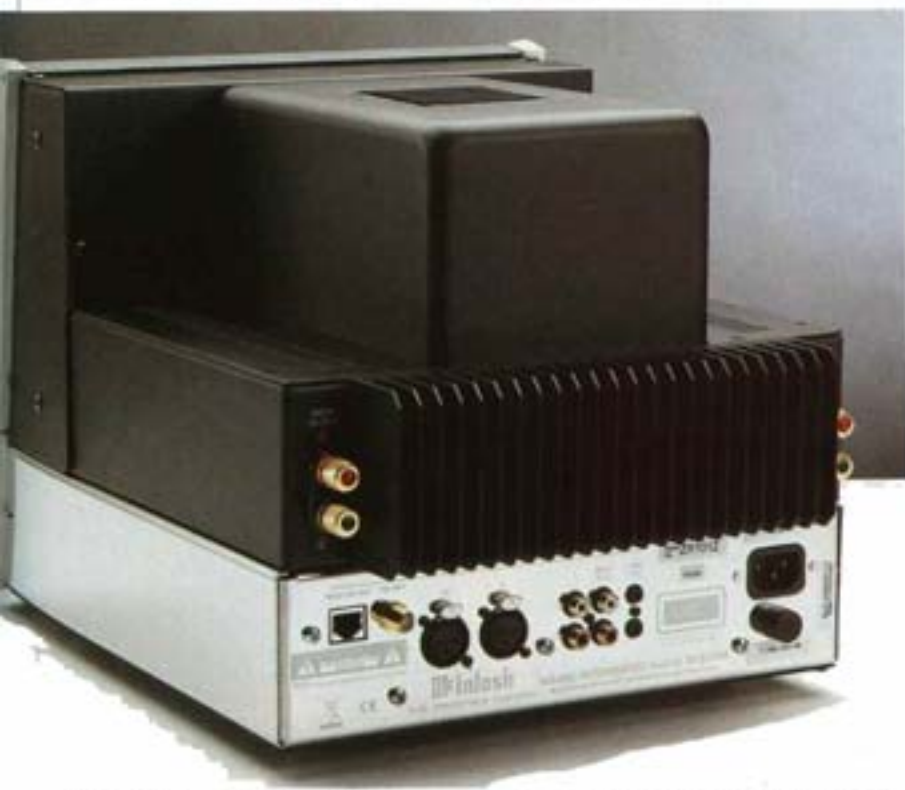
Poiché l'unità centrale integra le due sorgenti maggiormente utilizzate negli impianti audio, il lettore ed il tuner, sul pannello posteriore ci sono soltanto un paio di ingressi, uno dei quali bilanciato; le uscite a livello linea possono essere configurate per l'emissione di segnali stereo, ovvero mono + subwoofer.
