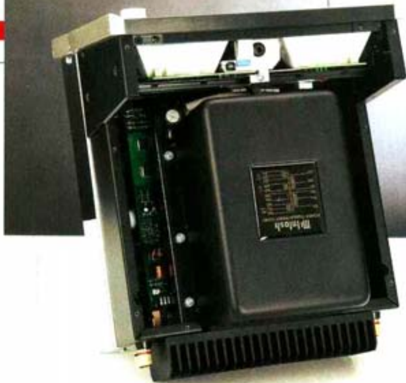
Come sempre succede con le elettroniche McIntosh, una importante frazione del volume a disposizione è occupata dal trasformatore di alimentazione: a causa della particolare struttura meccanica dell'apparecchio, questo blocco nasconde il grosso dei particolari.
